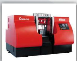
W pełni automatyczna, komputerowo sterowana przecinarka taśmowa typu CNC, przeznaczona do cięcia metalu. HFA-530CNC
