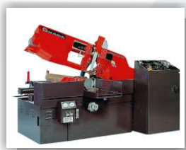
Uniwersalne przecinarki taśmowe o konstrukcji nożycowej, zarówno konwencjonalne oraz sterowane numerycznie. HA-250W HFA-250W HA-400W HFA-400W
